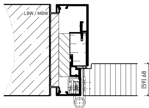
Aluminiumzarge, Türe stumpf
