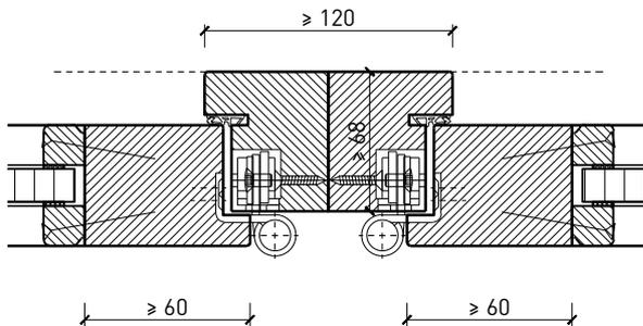
Blockrahmen-Kopplung 68 mm, Türe stumpf
