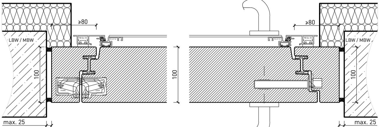
Blockrahmen 100 mm mit Blindstock, Türe stumpf
