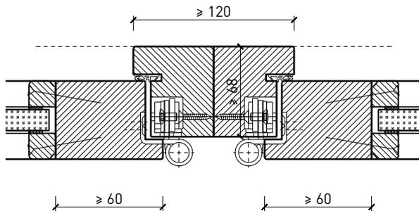
Blockrahmen-Kopplung 68 mm, Türe stumpf
