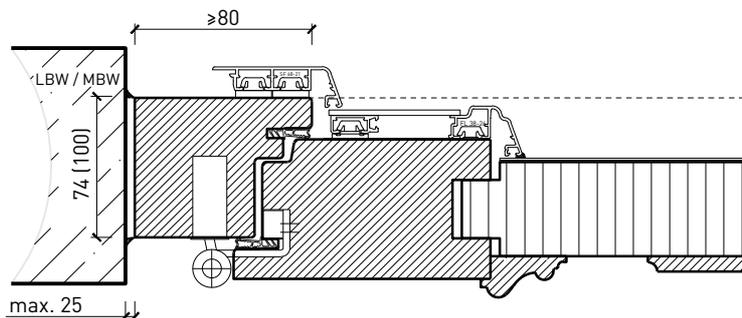
Mittelanschlag 74 / 100 mm, Schlagleisten profiliert
