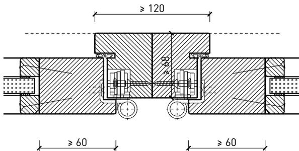
Blockrahmen-Kopplung 68 mm, Türe stumpf
