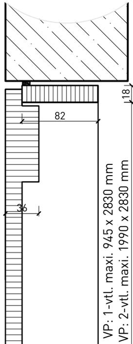
Raccord au plafond avec parement
