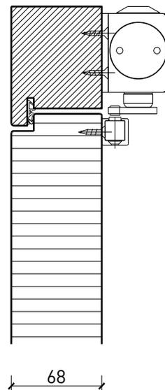
Butée avec joint d'étanchéité 40x30\*
