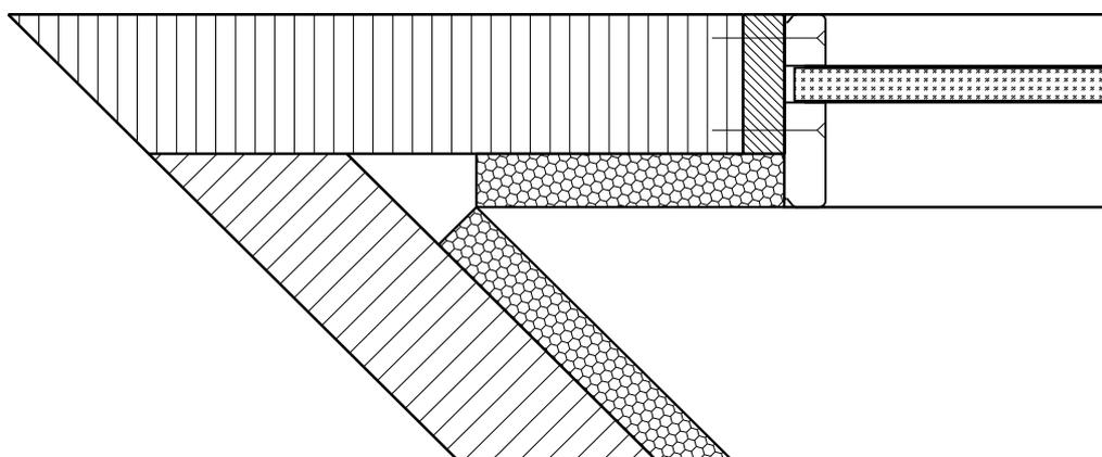
Combinaison entre cloison pour gaines techniques et paroi FeuerschutzTeam
