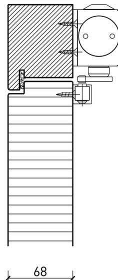
Butée avec joint d'étanchéité 40x30\*
