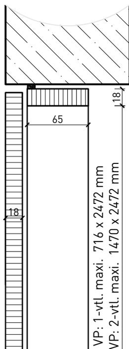
Raccord au plafond avec parement
