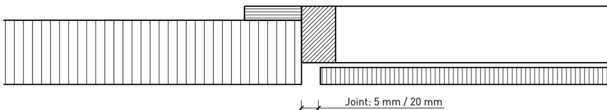
Combinaison entre cloison pour gaines techniques et vitrage FeuerschutzTeam
