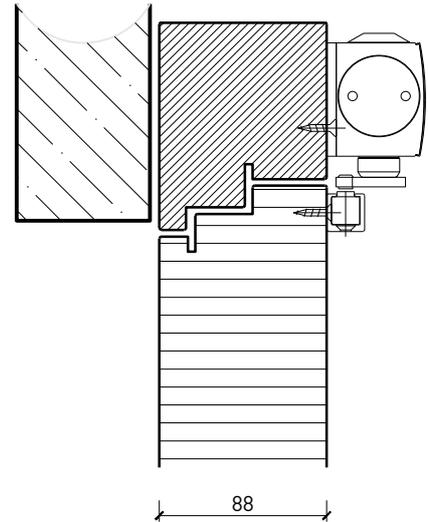
Butée avec joint d'étanchéité 40x30\*
