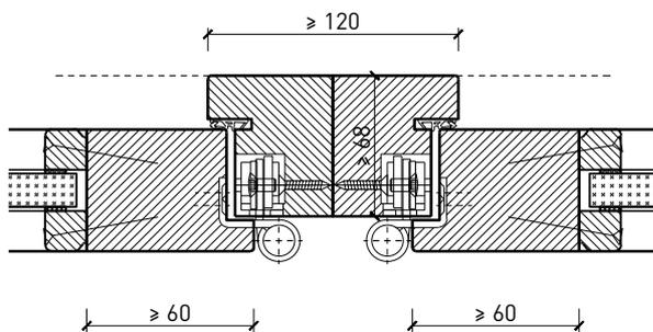
Blockrahmen-Kopplung 68 mm, Türe stumpf
